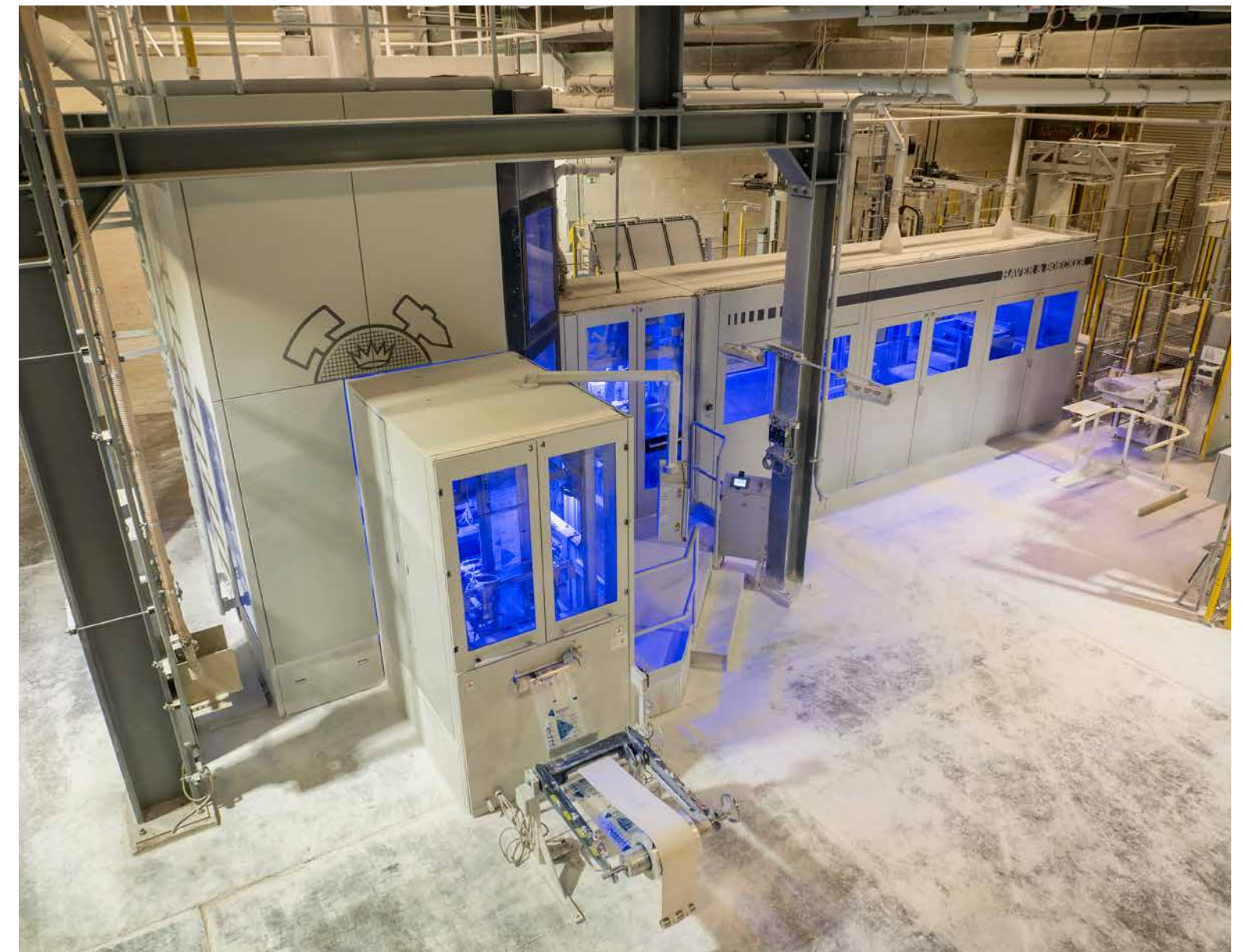
Met de FFS-verpakkinglijn is Kronos overgestapt van papieren ventielzakken op folieverpakkingen. (Foto: Vermeulen Ingenieursbureau)
